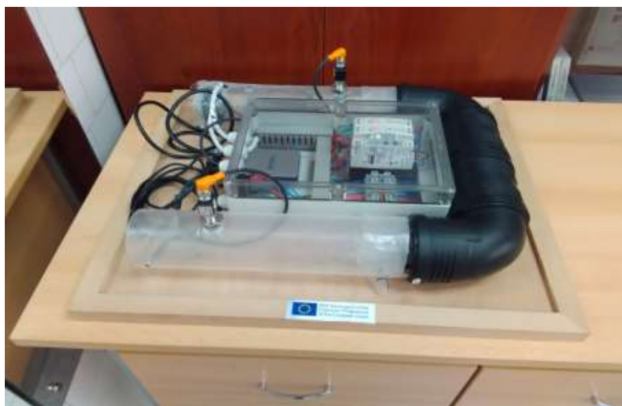
Слика 10 - објекат управљања ПИД система тип1 WP3
