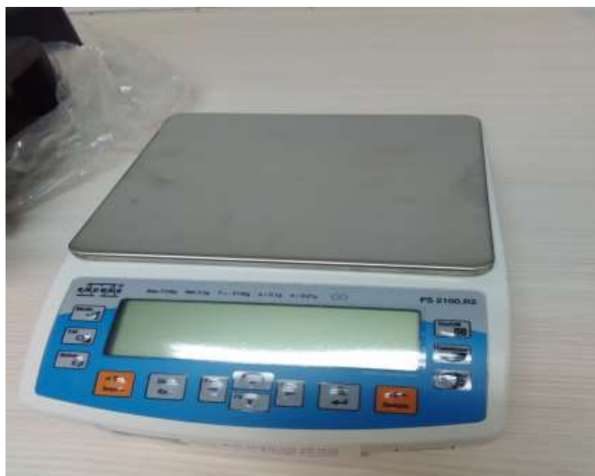
Слика 3 – техничка вага PS2100.R2 са системском интеграцијом RADWAG
