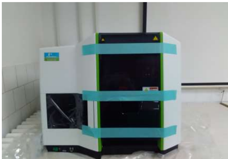
Слика 4 - атомски апсорбциони спектрофотометар PinAAcle 500 са припадајућом опремом и системском интеграцијом PerkinElmer
